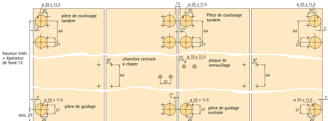
\* B Distance de perçage mm 16,5 17 17,5 18 18,5
