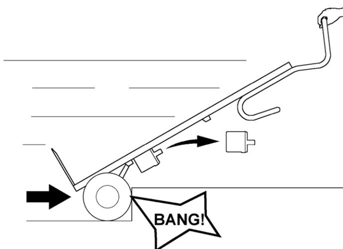
Pour toute opération normale le rack de batterie est maintenu en toute sécurité par les crochets de verrouillage. Il faut tirer fortement pour pouvoir la retirer. L'utilisation abusive du LIFTKAR en le des déplaçant très rapidement en arrière, et butant contre des hautes marches, ou similaires, entraînera l'éjection de la batterie.
