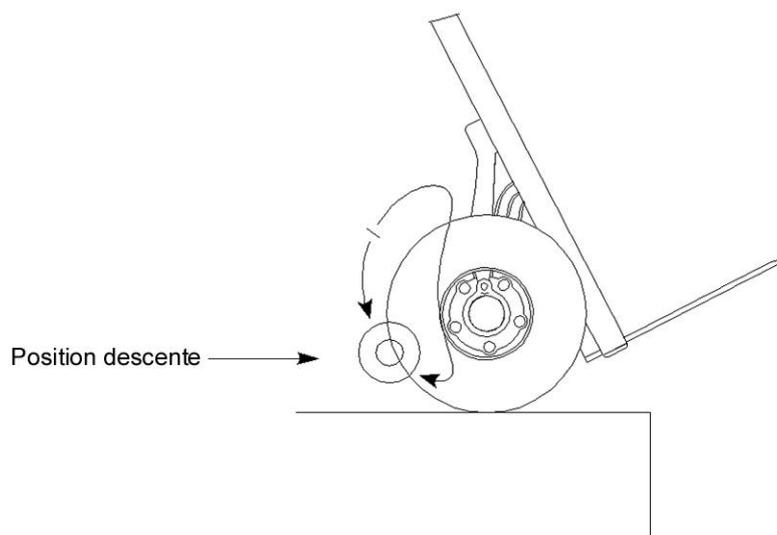
Avec les roues support en position descente, le LIFTKAR peut être roulé au-dessus du nez de marche et les roues supports vont, en conditions contrôlées, baisser la machine jusqu'à la marche inférieure. Lorsque les roues principales atteignent la marche inférieure, les roues support vont automatiquement pivoter jusqu'à la position descente pour descendre sur la marche inférieure suivante, ce qui prend environ une demi seconde.
