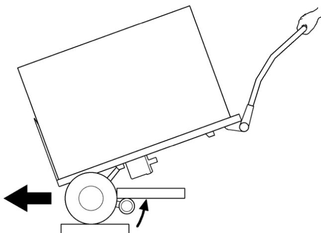
En condition normale d'utilisation, avec une charge bien équilibrée, le bras support se trouve toujours éloigné du dessous de la marche supérieure. Si le LIFTKAR est trop basculé vers l'arrière, le bras support va buter sous la marche qui le surplombe. Les commandes électro-niques vont se mettre en mode surcharge et devront être réinitialisées.
