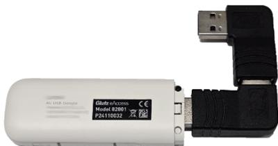
puis l'insérer dans la passerelle – dans l'interface USB supérieure:
