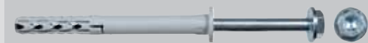
SXR-FUS – mit galv. verz. fischer 6-kant-Sicherheitsschraube und angeformter Scheibe sowie ausgeprägtem, flachem Dübellrand SXR-FUS A4 – mit 6-kant-Sicherheitsschraube und angeformter Scheibe aus nicht rostendem Stahl A4 sowie ausgeprägtem, flachem Dübellrand
