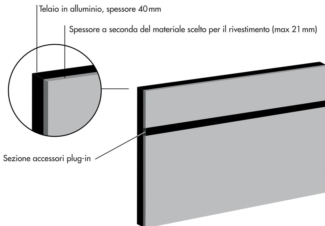
Ogni unità a parete posteriore viene prodotta su misura e può essere adattata e personalizzata a seconda dei desideri dell'utente. I diversi allacciamenti elettrici permettono di utilizzare la parete del tutto in base alle proprie esigenze e necessità.
